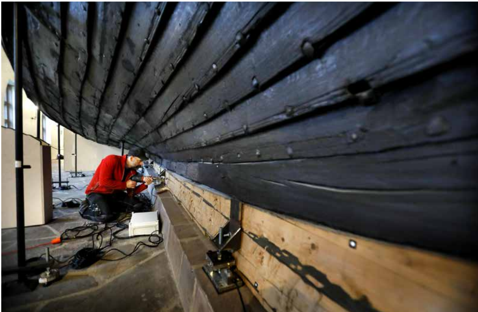
Støtte. Osebergskipet hviler på et solid fundament. 18 elektroniske veiesensorer er festet til treverket. Målingen blir viktig for å bestemme hvordan skipet skal flyttes.
